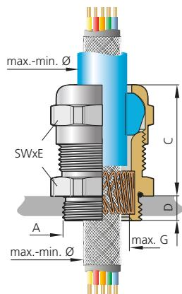
Abb. 3 – Variante A: abgesetzter Außenmantel
