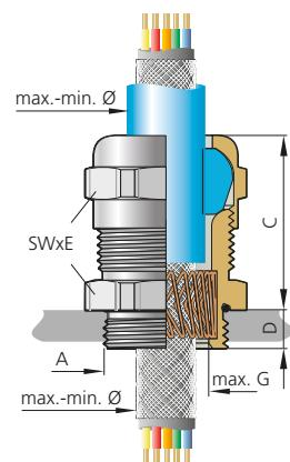
Abb. 3 – Variante A: abgesetzter Außenmantel
