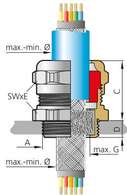
Abb. 3 – Variante A: abgesetzter Außenmantel
