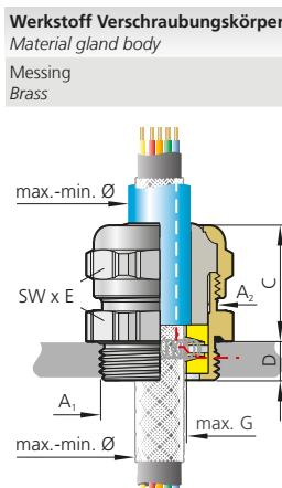
Abb. 3 – Variante A: abgesetzter Außenmantel
