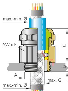
Abb. 3 – Variante A: abgesetzter Außenmantel
