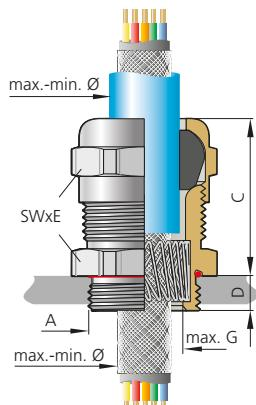
Abb. 3 – Variante A: abgesetzter Außenmantel
