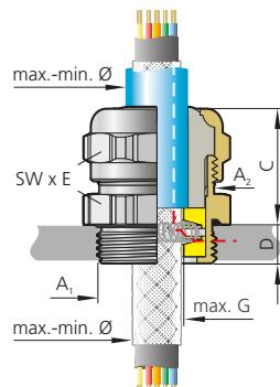
Abb. 3 – Variante A: abgesetzter Außenmantel
