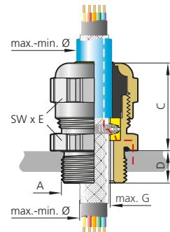
*Abb. 3 – Variante A: abgesetzter Außenmantel
