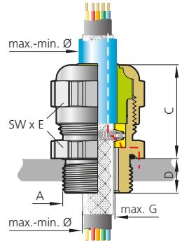
Abb. 3 – Variante A: abgesetzter Außenmantel
