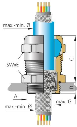
Abb. 3 – Variante A: abgesetzter Außenmantel
