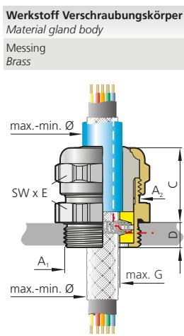
Abb. 3 – Variante A: abgesetzter Außenmantel
