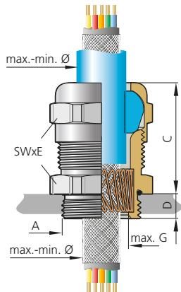
Abb. 3 – Variante A: abgesetzter Außenmantel
