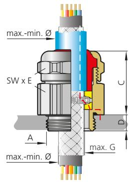
*Abb. 3 – Variante A: abgesetzter Außenmantel
